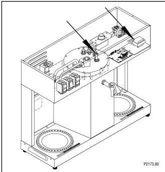
FIG. 12 LIQUID LEVEL PROBE & CONTROL BOARD
